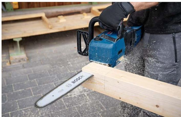
La GKE 18V-40 Bosch Professional dispose également de **la fonction OptiCut qui détecte les risques de calage du moteur. Elle réduit automatiquement la vitesse du moteur et augmente le couple pour effectuer, sans effort, des coupes continues**, fluides et nettes dans les bois les plus durs, même ceux avec des noeuds.
